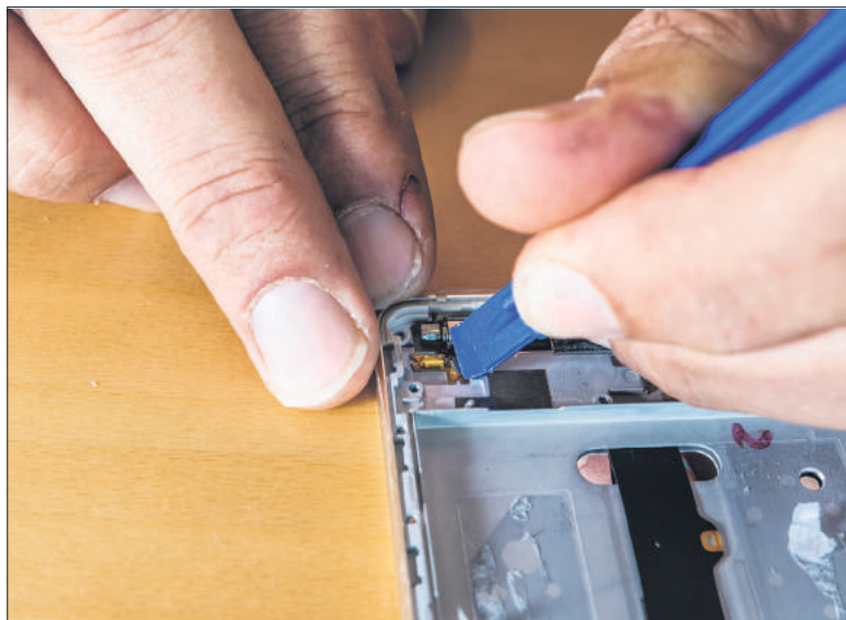
9 Entfernen Sie zum Schluss den Motor, der für Handy-Vibrationen zuständig ist. Er befindet sich rechts unten. Nehmen Sie das Plastikwerkzeug und heben Sie damit Kabel und Motor heraus.
