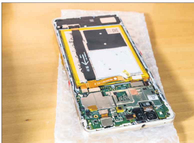
11 Bauen Sie die obere Platine ein. Verbinden Sie alle Kabel mit den richtigen Steckern. Setzen Sie den oberen Metaldeckel und die untere schwarze Plastikabdeckung ein. Verschrauben Sie diese.
