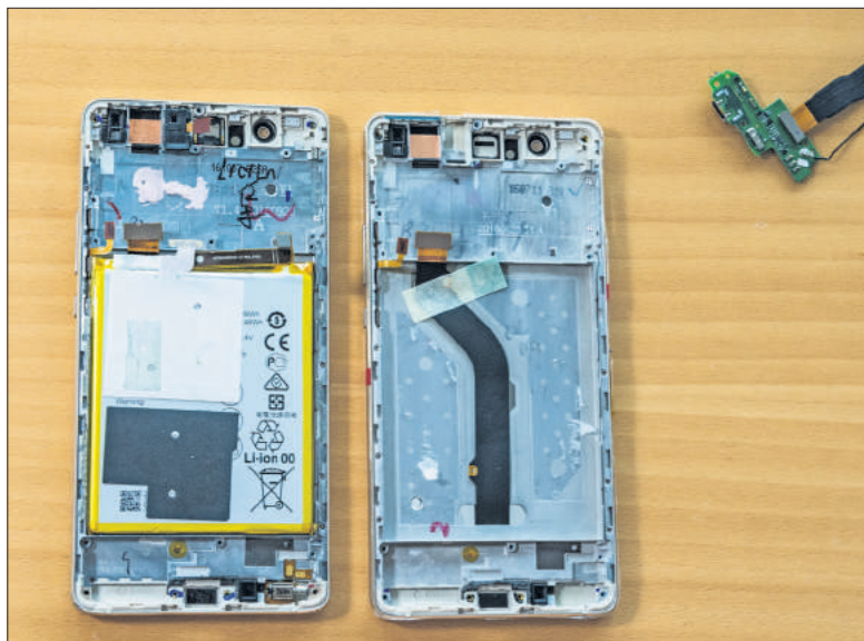
7 Alter und neuer Display-Rahmen (rechts): Holen Sie beim alten Handy mit einer Pinzette Lautsprecher und Klinkenbuchse heraus. Beide Komponenten befinden sich am oberen Seitenrand.
